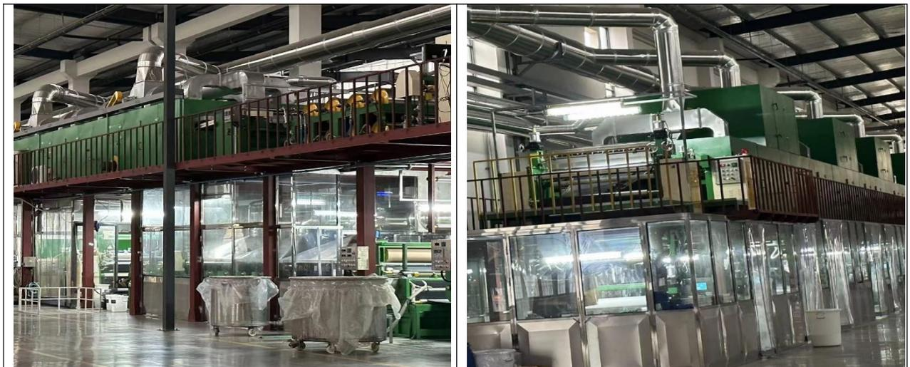
干法/三版印刷涂台、烘干段封闭，负压集气
